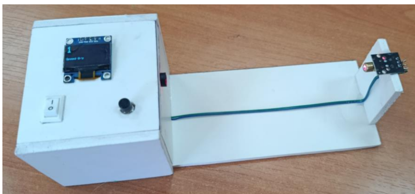
Рис. 3. Экспериментальный макет открытой оптической линии связи на базе Arduino с лазерным передатчиком и фотоприёмным модулем.
