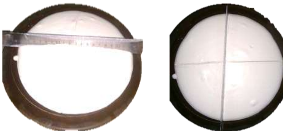
2.12-rasm. Gipslikeramzitbetonning xamirini quyuqlanish davrini kuzatish.
