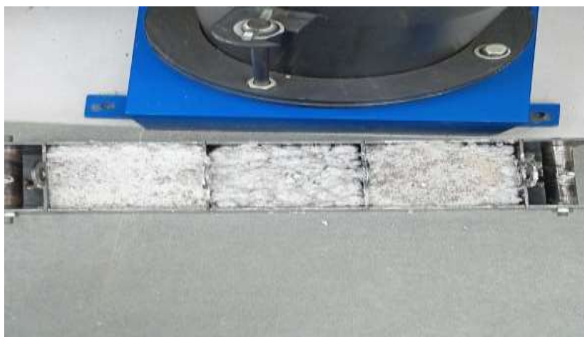
1-rasm. Gipslikeramzitbeton namunalarini qoliplarga joylash jarayonlari
